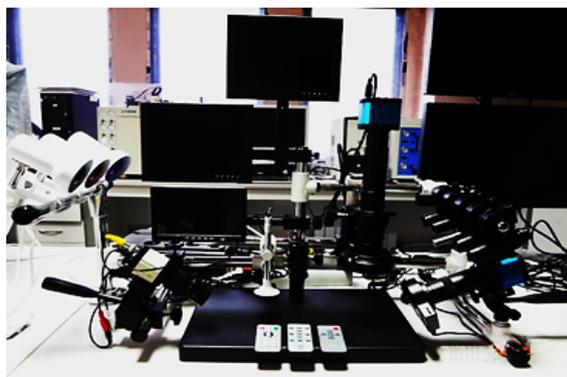
Рис. 9. Криминалистический многофункциональный Видео-Микроскопический спектральный комплекс / Forensic multifunctional Video Microscopic spectral complex.
